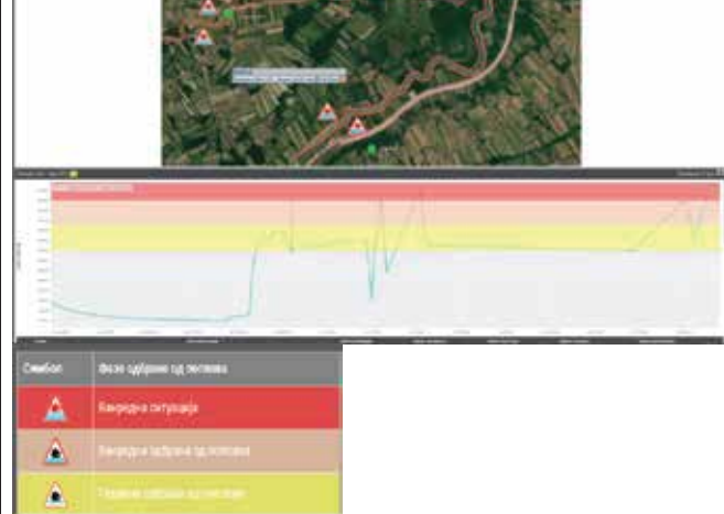
Упозоравајући нивои из апликације система РНУ Колубара, пример
